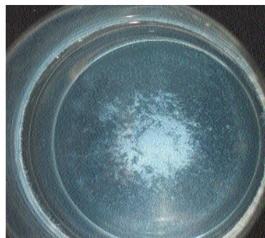
Das ist der Rückstand von nur einer Tab die im Tank und Leitungen verbleibt
