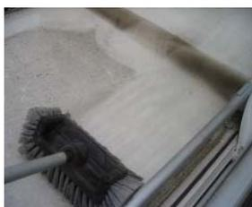
RegenstreifenEx mit 2 l Wasser verdünnt (1:100) und sprühen damit Dach oder Deck ein. Dann entfernen Sie den Schmutz mit einer Waschbürste und spülen das Dach mit viel Wasser ab.
