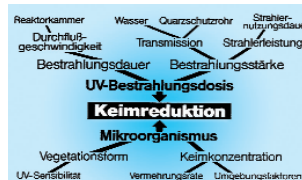
Bild: Einflussgrößen bei der UV-Bestrahlung: Aus: UV-Desinfektion von Trinkwasser, Expert Verlag
