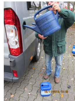
FrostEx Mischung einfüllen in den Trinkwassertank
