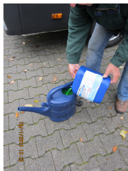
Mischungsverhältnis für - 22 °C 1 l MFE und 2 l Trinkwasser
