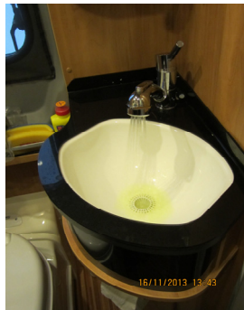
Warm- und Kaltwasser in Bad und Dusche mit FrostEx spülen
